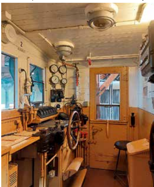
Jednoduše zařízené stanoviště elektrické lokomotivy ze začátku minulého století
