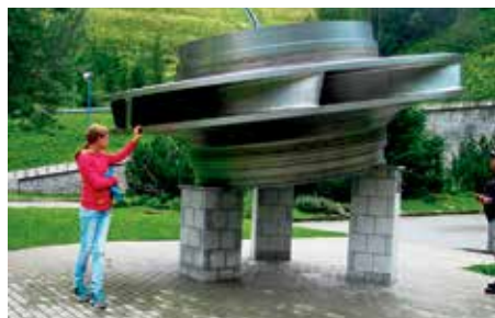
Oběžné kolo Francisovy turbíny před přečerpávací elektrárnou Dlouhé stráně
